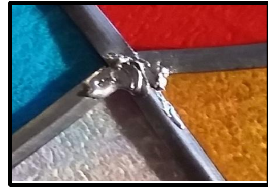
Collage plutôt que soudure
